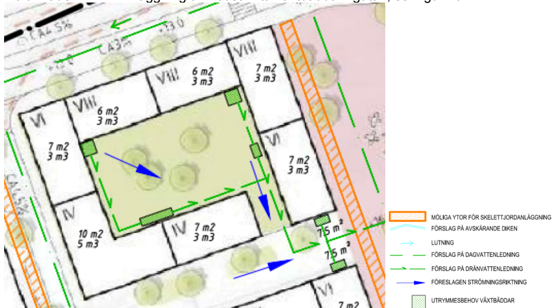
Figur 10: Exempel på placering av växtbäddar, dräneringsledningar och avrinningsvägar på delområde 2-4 och T1, T2. Fastigheternas fördröjningskrav och växtbäddarnas utrymmesbehov redovisas på varje fastighet (för krav på mängd växtbäddar se Bilaga 1 och för föreslagen utformning se Bilaga 5)
