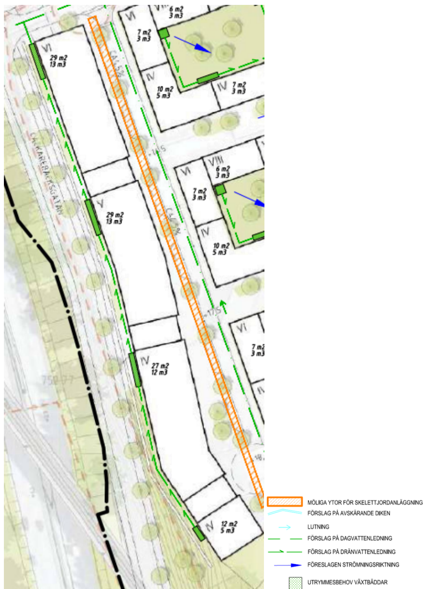
Figur 9: Exempel på placering av växtbäddar, dräneringsledningar och avrinningsvägar på delområde 1. Fastigheternas fördröjningskrav och växtbäddarnas utrymmesbehov redovisas på varje fastighet (för krav på mängd växtbäddar se Bilaga 1 och för föreslagen utformning se Bilaga 5)
