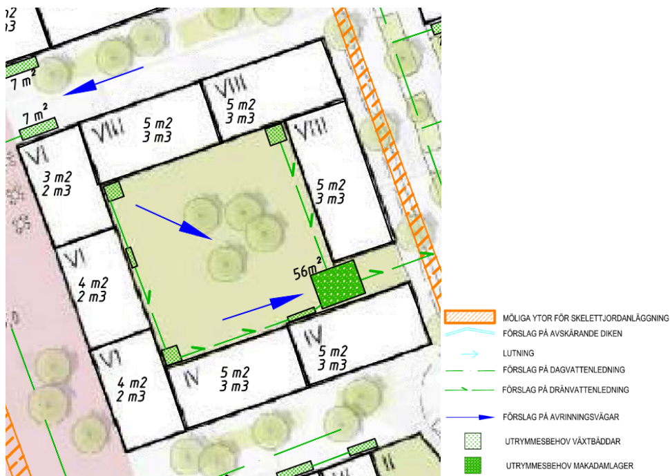
Figur 25: Exempel på placering av växtbäddar, makadamlager, dräneringsledningar och avrinningsvägar. Fastigheternas fördröjningskrav och växtbäddarnas utrymmesbehov redovisas på varje fastighet (För krav på mängd växtbäddar och makadam se Bilaga 1 och för föreslagen utformning se Bilaga 6)
