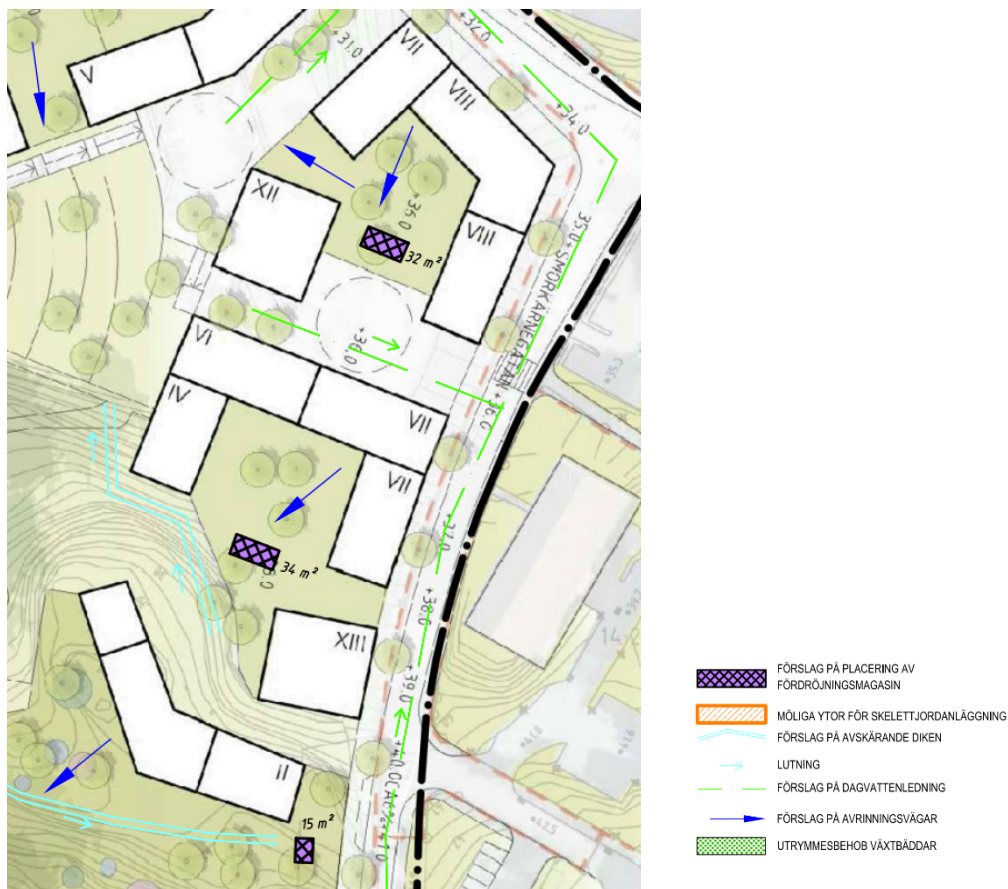
Figur 36: Exempel på placering av kassetter. För krav på dagvattenkassetter se Bilaga 1 och för föreslagen utformning se Bilaga 7.
